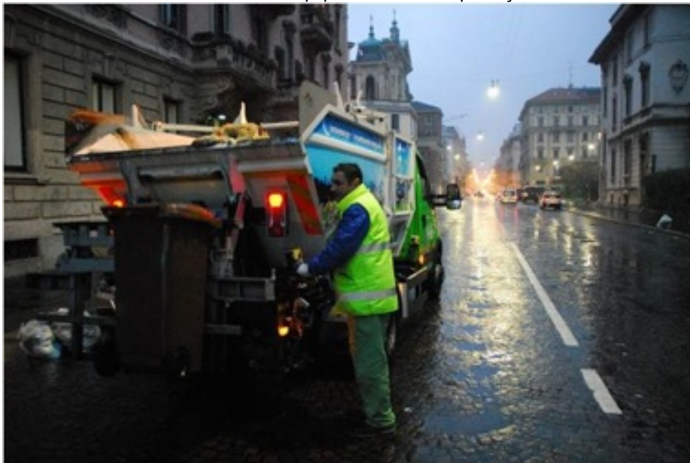
Figura 19: Coleta seletiva porta a porta de resíduos orgânicos realizada em Milão por caminhões que não necessitam de equipamento de compactação
